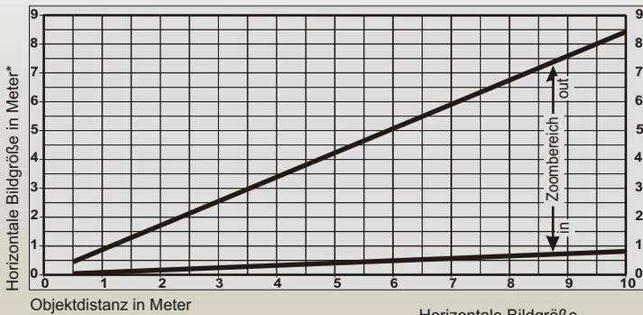
$$* \text{Vertikale Bildgröße} = \frac{\text{Horizontale Bildgröße}}{4} \times 3$$
