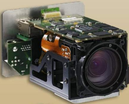
Die Kameramodule der WolfVision SCB Serie sind identisch mit den Kameras der EYE Serie. Sie werden jedoch ohne Gehäuse und Zubehör verkauft:
