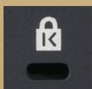
Die Kameras der EYE Serie sind mit **T-Lock (Kensington® Lock) Diebstahlschutz** ausgestattet.
