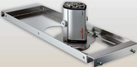
Die **Tile Bridge** ist eine Halterung um die Kameras der EYE Serie in ein Standard **Deckenelement** mit 60 x 60 cm oder 60 x 120 cm einzubauen. Sie ist aus Aluminium gefertigt und somit sehr leicht und robust. Sie passt für Deckenelemente nach dem Europäischen und Amerikanischen Standard.
