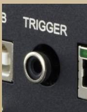
In der Grundeinstellung der EYE-12 wird ein Livebild mit 30 verschiedenen Bildern pro Sekunde ausgegeben. Im "**Trigger Modus**" zeigt die EYE-12 jedoch nur dann ein neues Bild, wenn sie einen **Trigger-Impuls** von einem externen Gerät erhält. Das selbe, **eingefrorene** Bild wird so lange ausgegeben, bis die EYE-12 den nächsten Trigger-Impuls erhält.
